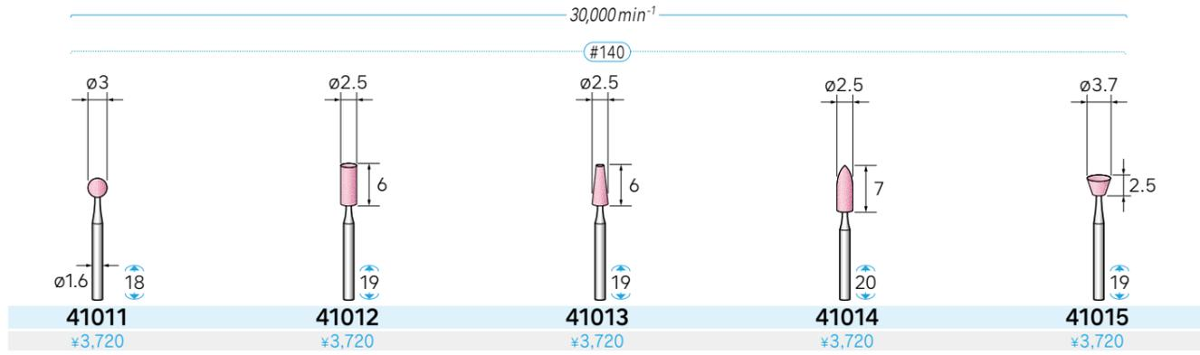
軸径φ1.6 10本入 GC V M グリーン 主な被削材…セラミックス、ガラス、FRP、石材、超硬材の一般研削。
