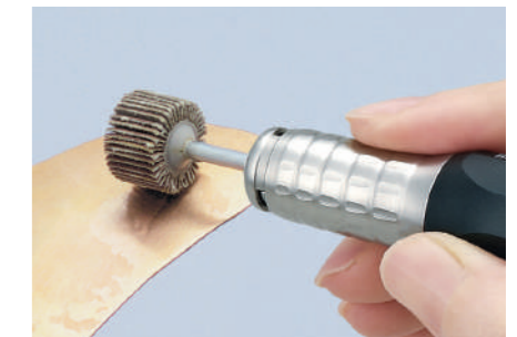
使用先端工具:フラップサンダー →別冊TOOLSカタログをご覧ください。
