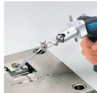
軸径 φ3.0 1本入 電着ダイヤモンドヤスリ
