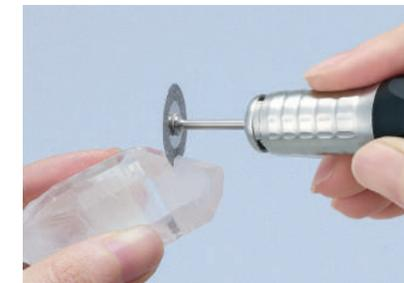
使用先端工具:ダイヤモンドカッティングディスク
