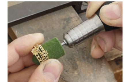
使用先端工具:フェルトバフ
