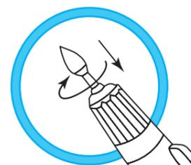
コレットの締め付けは確実に行ってください。作業中に先端工具が抜けたりしないように、チャッキング(取り付け)は確実に奥まで差し込んでから行ってください。
