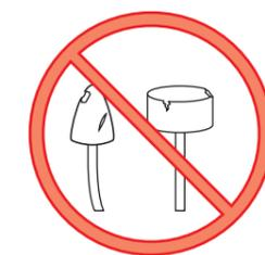
先端工具はご使用前に必ず点検を行ってください。割れ、欠け、亀裂、キズ、接着不良、軸の曲がり等の異常がないことを確認してください。
