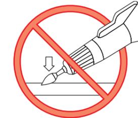
作業に際しては無理な圧力をかけたり、こじめる事は工具が折れたり曲がったりしてたいへん危険ですので行わないでください。適切な圧力でご使用ください。必要以上の作業圧力は工具の異常磨耗、めつまりの原因となり作業能率を低下させます。
