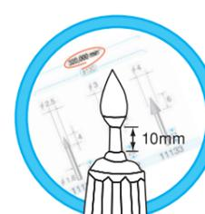
工具はオーバーハングに注意をして、最高使用回転速度又は許容周速度の範囲内で作業を行ってください。カタログではオーバーハング 10 mm (コレット先端から工具の刃部首下までの距離) における最高使用回転速度を表示しています。
