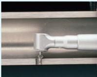
◆最小加工穴径:φ13mm ◆工具カミシロ:7.2mm
