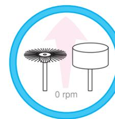
工具は最初は低速で回し安全を確認しながら徐々に回転速度を上げてください。初めて使用する工具や刃部の頭が大きい工具、弾性のある(ゴム砥石、サンダー、ブラシ、工具等)
